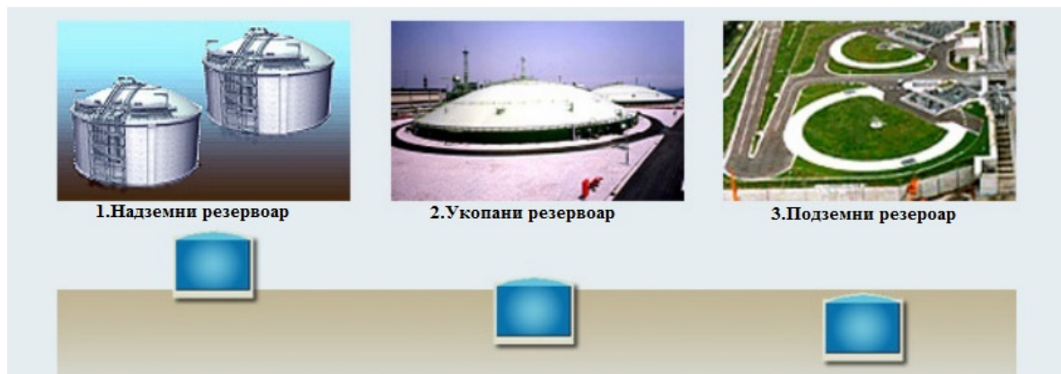
Слика 5. Приказ изградње три врсте резервоара
