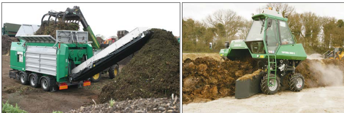
Слика 3. Технологија компостирања [18]: Мобилни млин за уситњавање отпада (лево) и савремени превртач компоста (десно)
