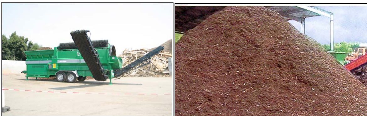
Слика 4. Технологија компостирања [18]: Мобилно бубањ-сито за фракционисање компоста (лево) и готов компост пре просејавања (десно)
