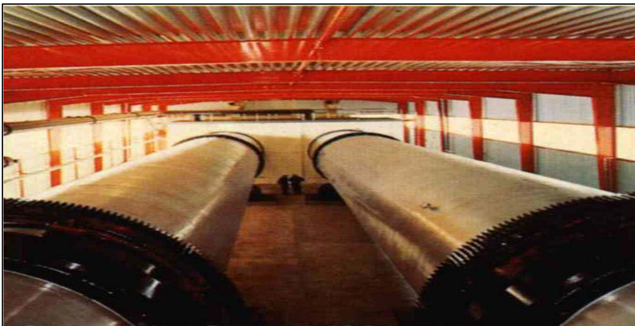
Слика 34. Компостирање у затвореним судовима, тзв. реакторима [23]
