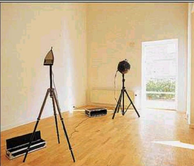
**Merenje izolacione moći pregrade vrši se primenom tercnih filtera u opsegu 100÷3150Hz.**
