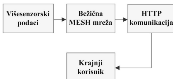
Slika 7. Komunikacijska arhitektura prenosa podataka
