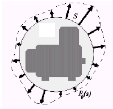
Слика 2. Модел реалног звучног извора представљен површином S правилног облика која потпуно обухвата извор буке и емисијом звучног притиска на тој површини
