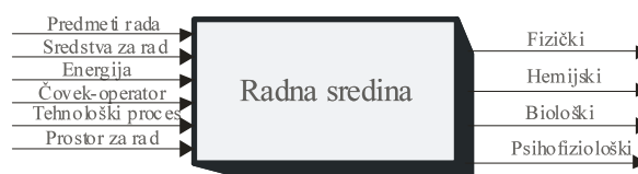
Слика 1. Блок дијаграм система радне средине са улазним карактеристикама и својствима елемената система
