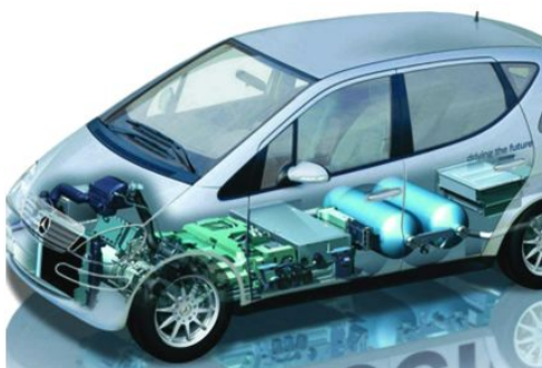
Слика 3.3: Мерцедес-ов аутомобил NECAR III са погоном на гориве ћелије [42]
