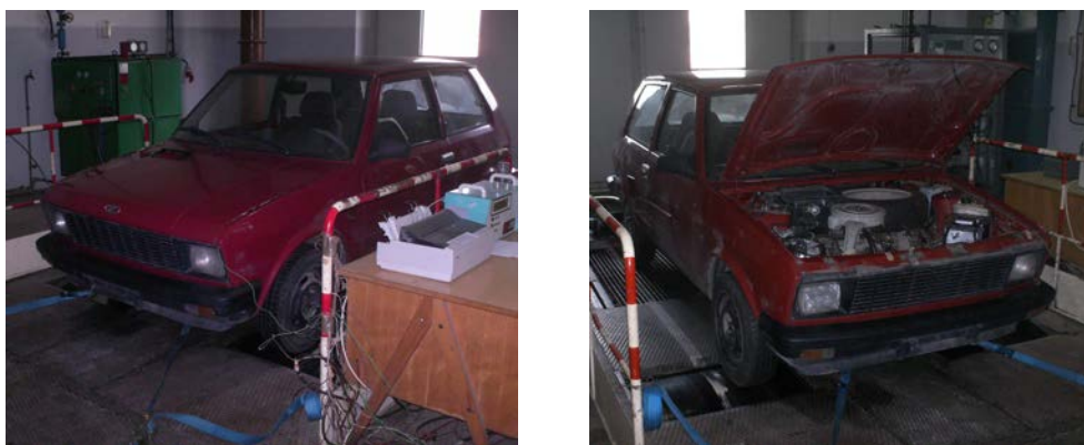
Слика 2.6: Возило Југо 1,3 CW на динамометарском ваљаку SCHENK LNC–0052
