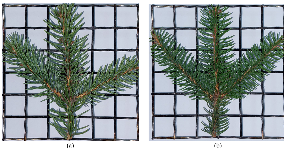
Слика 3.3. Специјално дизајниран носач узорака са постављеним узорцима: (а) гранчица јеле ( A. alba ); (б) гранчица смрче ( P. abies )
