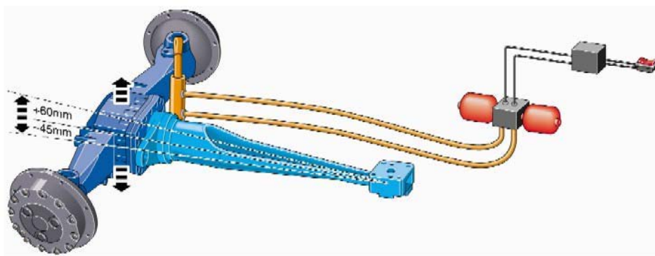
Slika 6.6. Nju Holandov 'Terraglide' sistem elastičnog oslanjanja na prednjoj osovini (Scarlett i os., 2005.)
