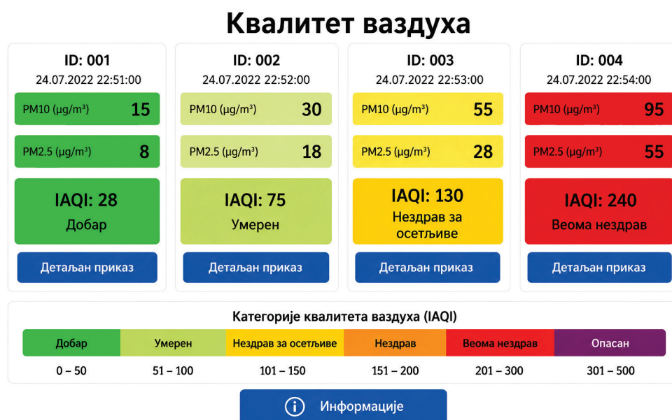
Слика 3.34. Пример структуре web интерфејса за приказ резултата мерења са више сензорских чворова
