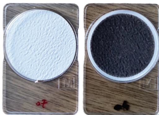
Слика 4.6. Whatman QM-A (47 mm) филтери пре и након експонирања
