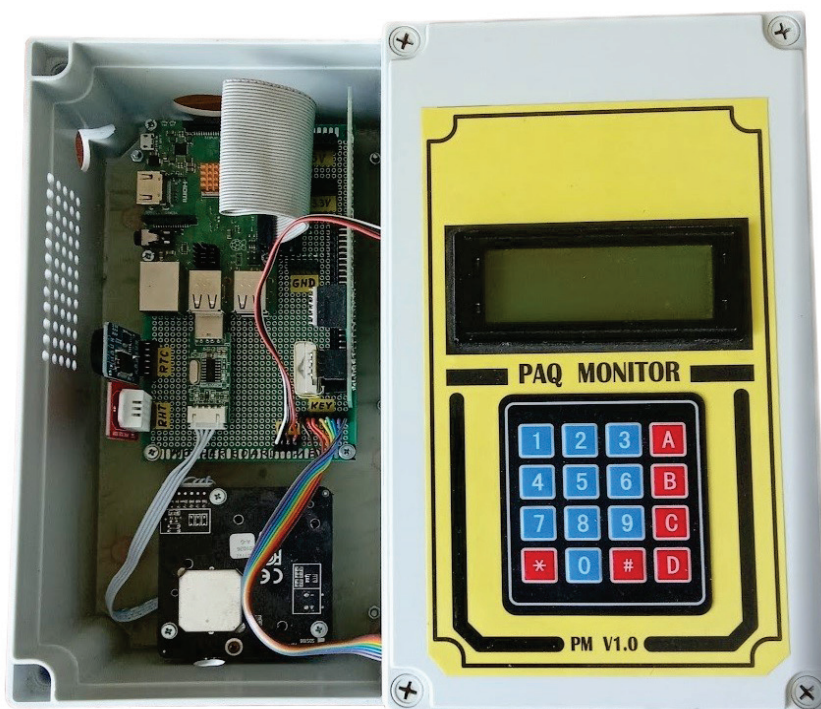
Слика 3.28. Реализовани PM-MoN мрежни чвор на бази Raspberry Pi платформе
