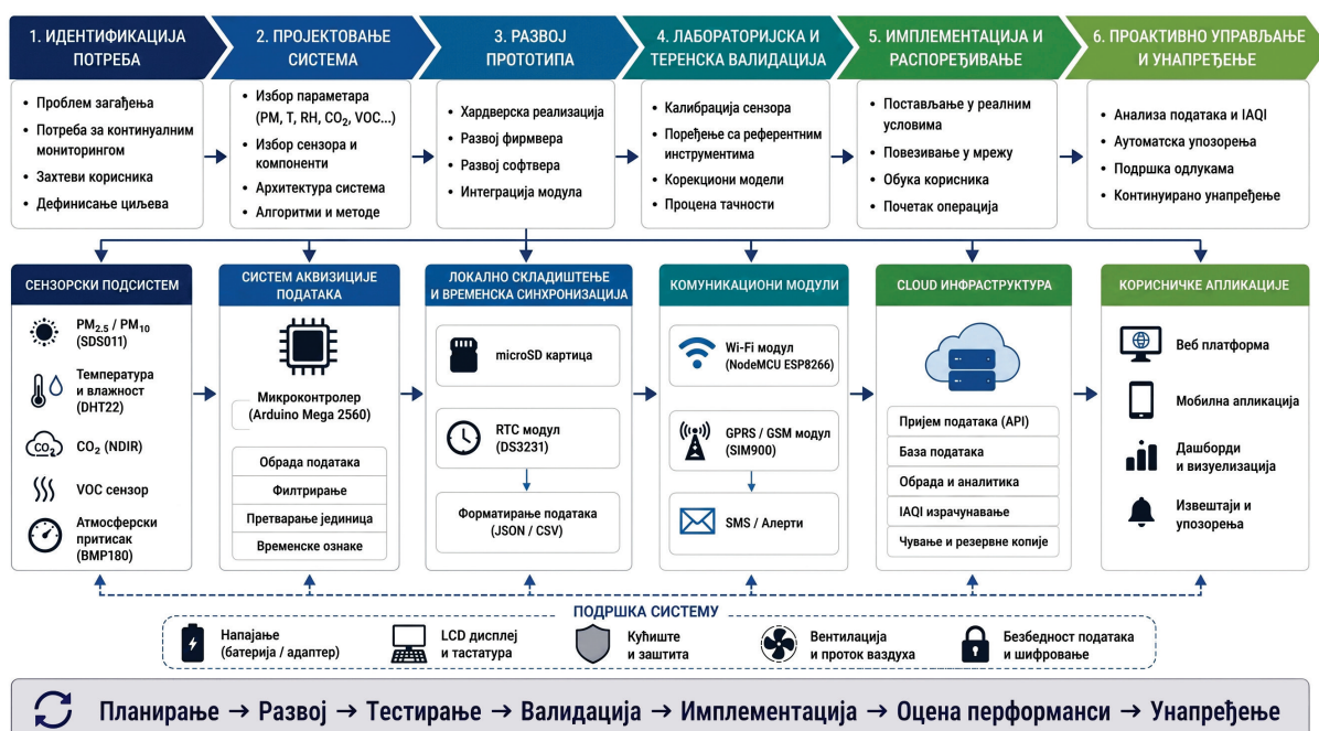
Слика 3.8. Концептуални модел развоја система проактивног мониторинга суспендованих честица
