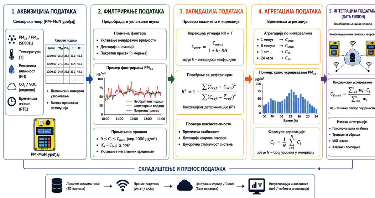
Слика 3.31. Ток обраде података: аквизиција – филтрирање – валидација – агрегација – интеграција
