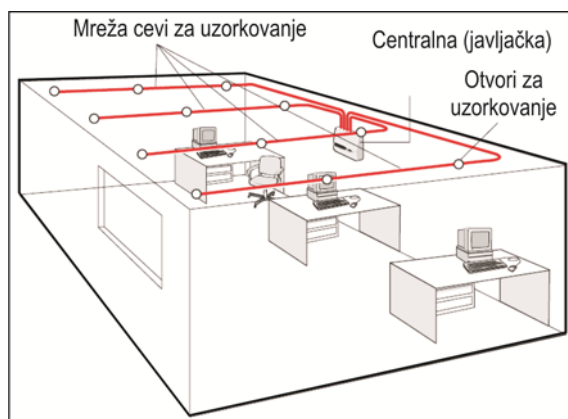
Slika 8.12 Postavljanje usisnog sistema za dim
