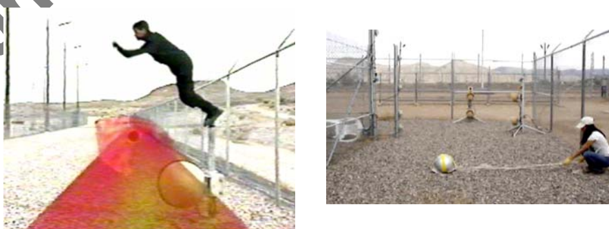
Slika 24.17 Načini testiranja rada mikrotalasnih detektora pokreta
