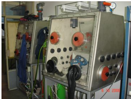
boks u kome je simuliran kratak spoj
