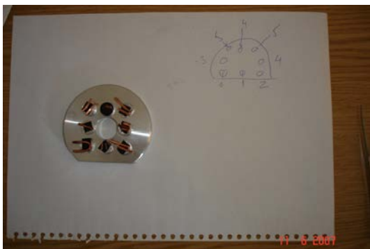
pripremljeni uzorci za SEM sa EDAX-om
