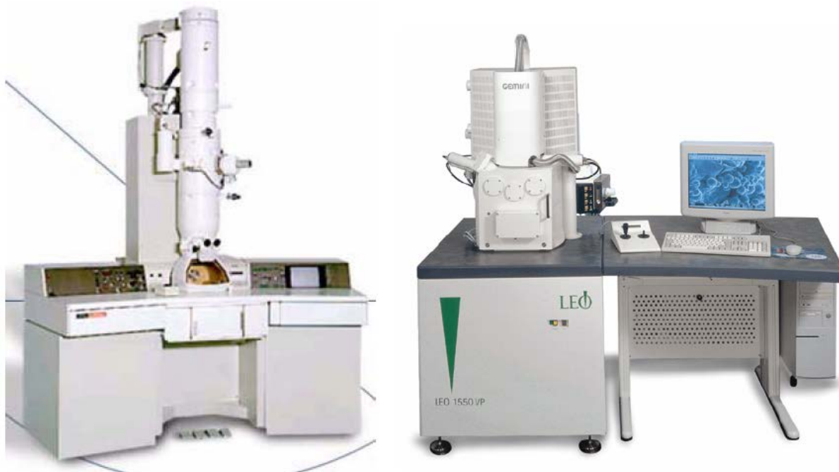
izgled skenirajućeg i transmisionog elektronskog mikroskopa i karakteristike pojedinih tipova
